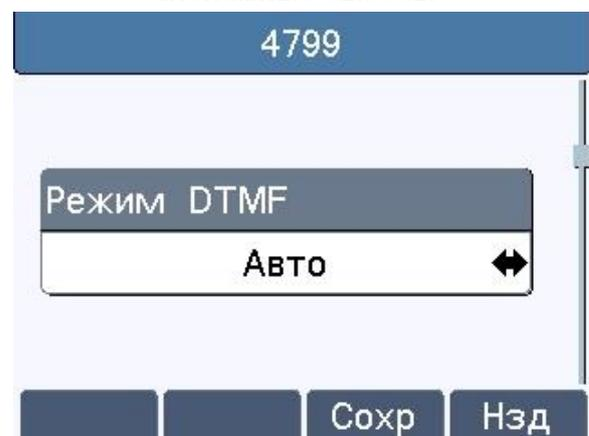
Рис. 21 – Настройка режима работы DTMF
