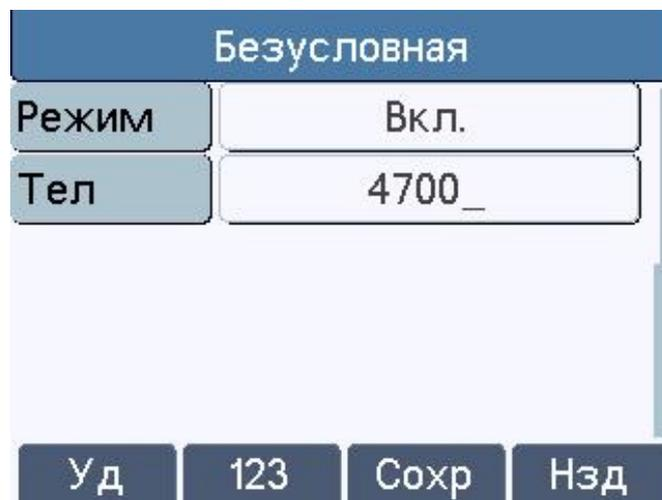
*Рис. 60 – Настройка безусловной переадресации*
