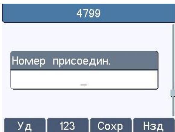
**Рис. 28 – Настройка номера присоединения к разговору**
