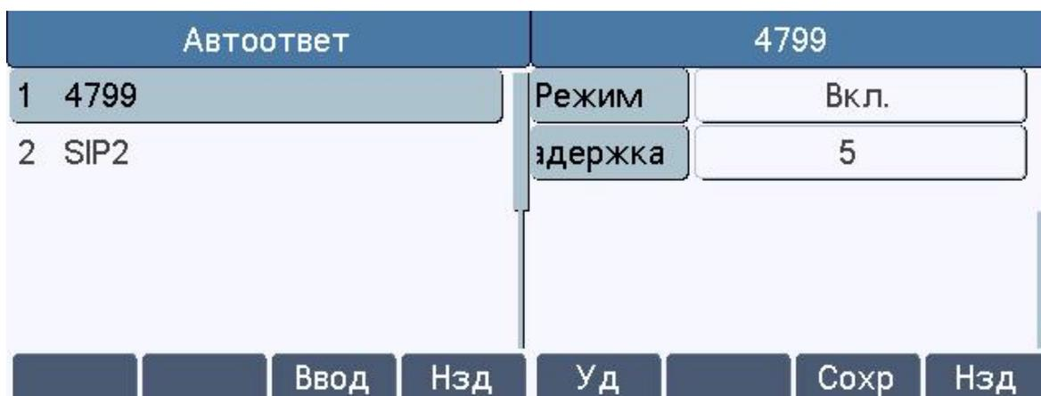
Рис. 57 – Настройка автоответа для линии 1
